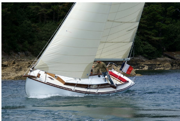
Toulinguet sous spi asymétrique. Un spi symétrique est bien sûr possible. Noter sur les plans que le rouf de ce premier Toulinguet est maintenant modifié pour donner plus de hauteur sous barrot, tout en conservant le même profil d'hiloire.
